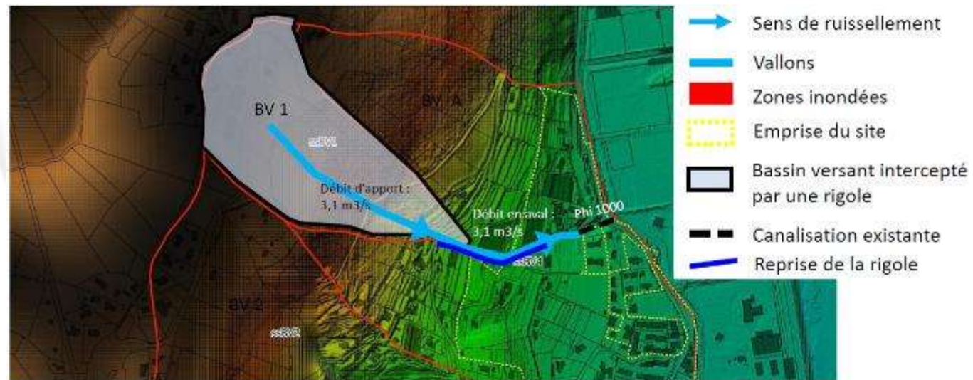
Figure 190 : Risque inondation, secteur nord, après aménagement (principes)
