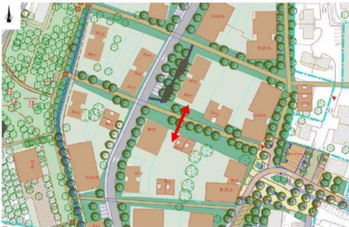
Figure 60 Noues de régulation et de compensation des voiries
