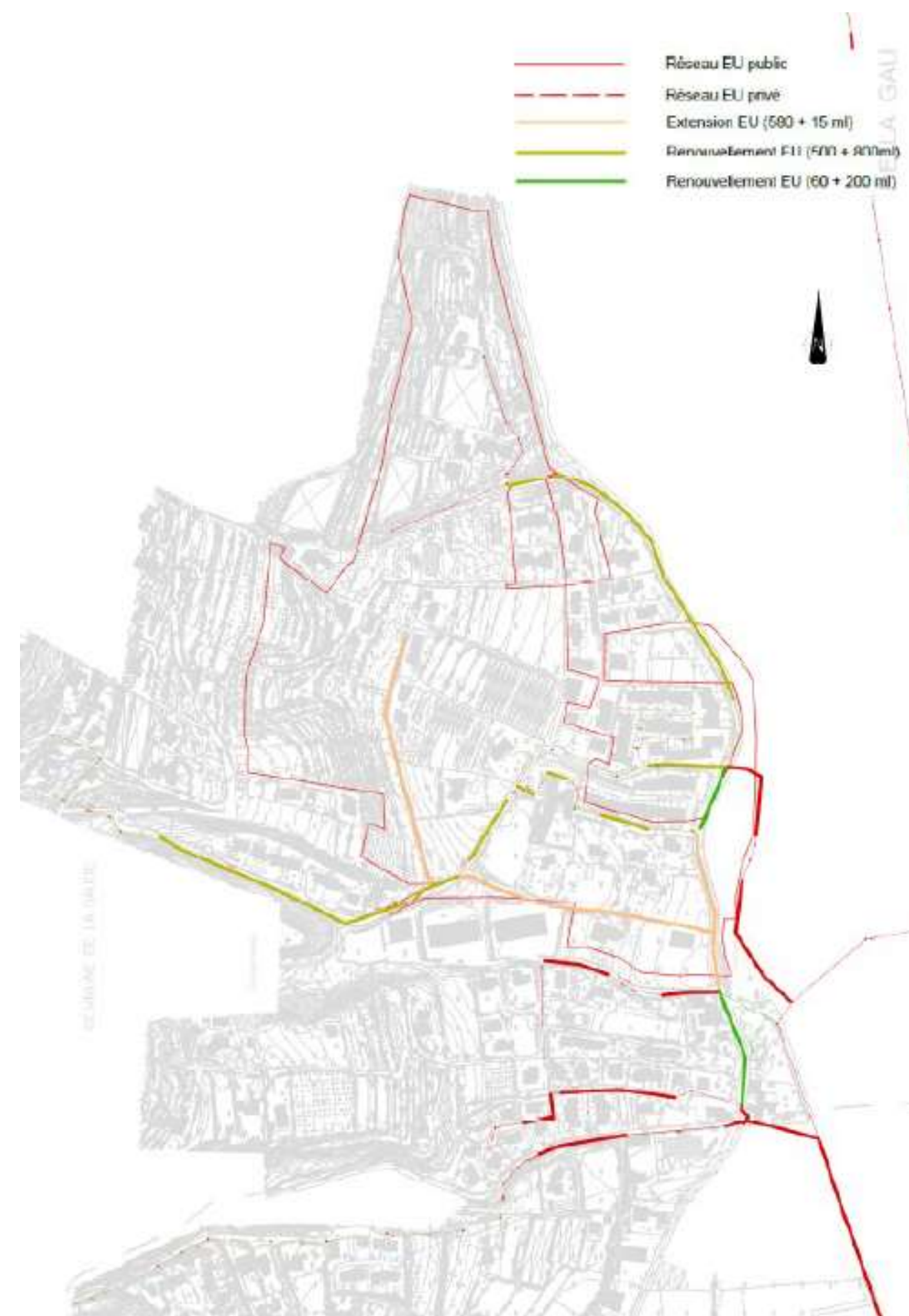
Figure 88 : Réseau d'assainissement (eaux usées)
