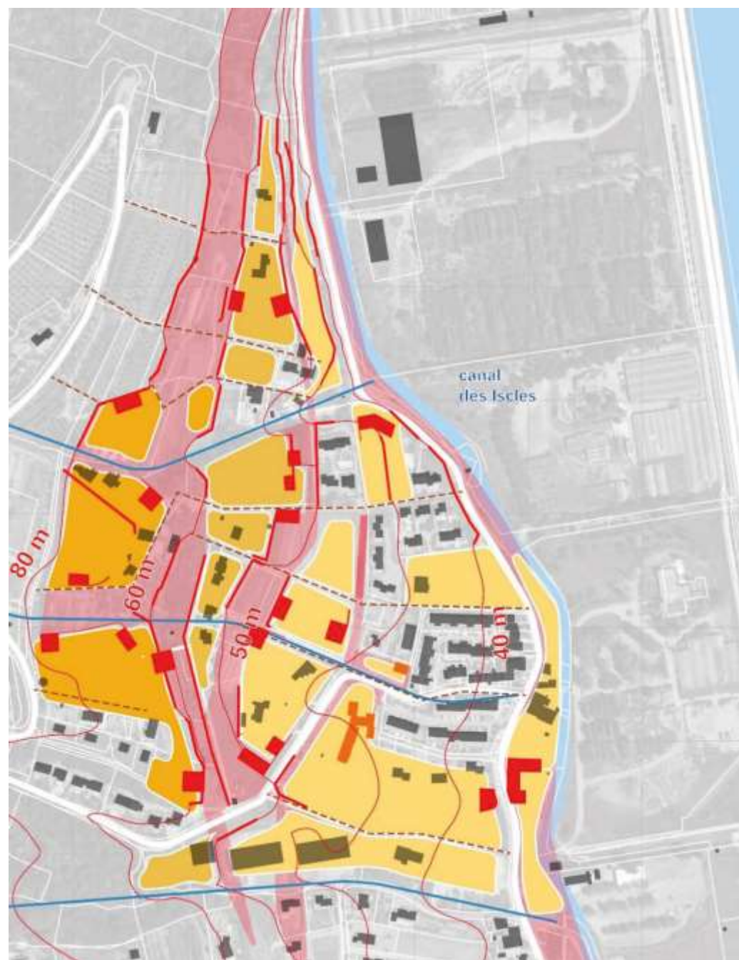
Figure 32 : Principes d'aménagement : favoriser la porosité paysagère est/ouest (pointillés rouges) pour dégager les futurs îlots à construire (en jaune) ; mettre en valeur le paysage par des pièces bâties (en rouge)
