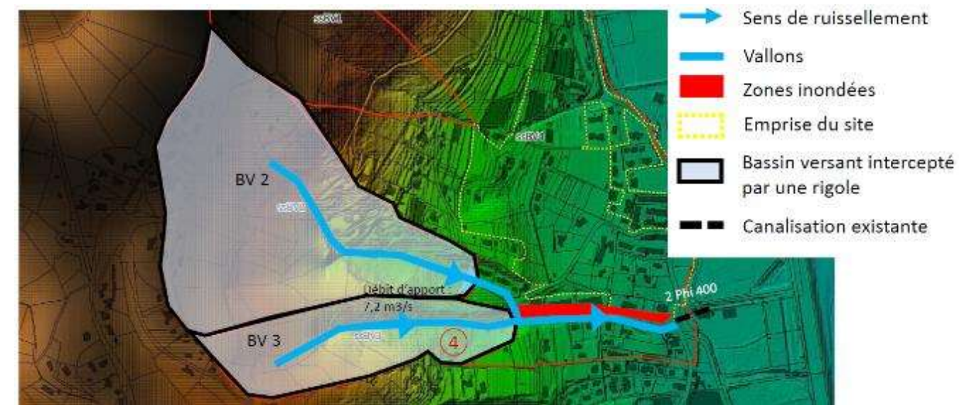
Figure 191 : Risque inondation, secteur sud, avant aménagement
